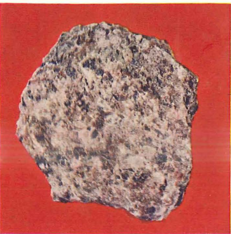
Fig. 3.11. Lys eruptiv (granit), bestående af mineralerne kvarts, feldspat og glimmer. Findes udbredt som faststående formationer over størstedelen af Skandinavien.
