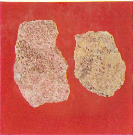
Fig. 3.10. 2 stk. sandsten. Sandsten findes faststående adskillige steder i Skandinavien. Bindemidlet mellem sandkornene kan indeholde mindre mængder af alkaliopløselig kisel.
